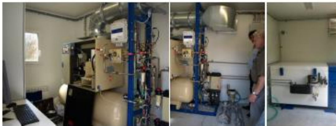
Obrázek 3. Fotografie jednotlivých částí prototypu zařízení pro dosažení extrémně nízké koncentrace radonu (řídící jednotka a kompresor se vzdušníkem; adsorpční sušička, odběrní ventily a měřící zařízení; chladič box).
